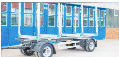
Schemel-Anhänger, tech. 20 ton mit 4 Schemeln, Gewicht 3300 Kg, zwillingbereift
